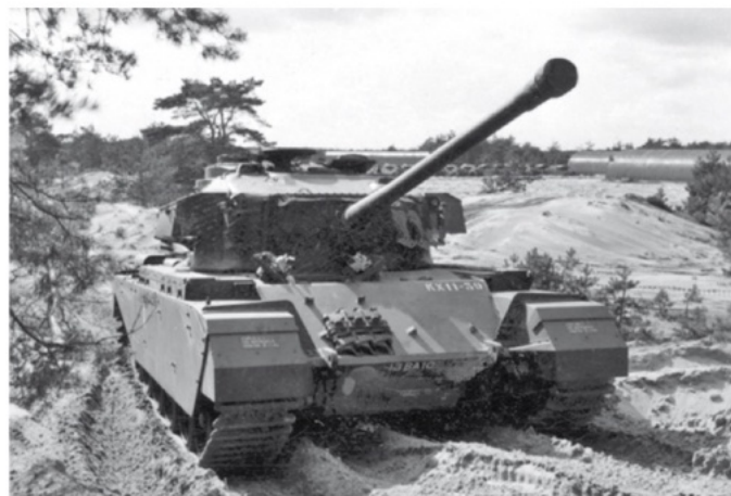
▲ Centurion Mk.3 gevechtstank KX-11-39, nog voorzien van een Brits kenteken 43BA10 en bewapend met een 20-ponder kanon
