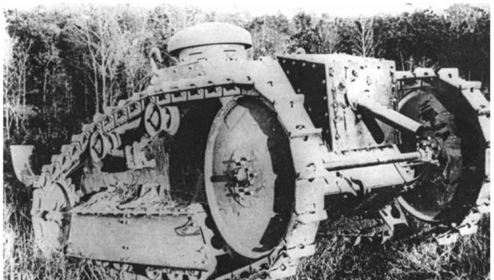
Dit pilot model van de Ford lijkt grotere voorwielen te hebben, een meer prominente mitrailleuropstelling en een grotere toren met een luik voor de bestuurder.
