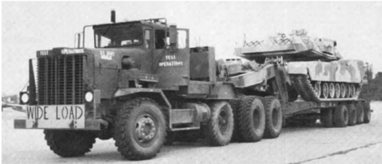
Oshkosh M911 met M747, gefotografeerd tijdens tests, met een XM1 als lading.
